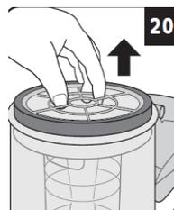
Entnehmen Sie den Separator, und heben Sie den Separator heraus.
