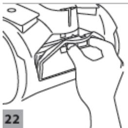
Drücken Sie die Taste zur Entriegelung der Ausblasfilter-Abdeckung und klappen Sie die Ausblasfilter-Abdeckung nach hinten weg (Abb.22).
