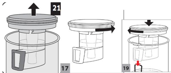
Nehmen Sie den Separator samt Separator-Deckel aus dem Staubbehälter. Entriegeln Sie den Separator-Deckel. Nehmen Sie den Separator-Deckel ab. Entnehmen Sie den Separator und entsorgen Sie seinen Inhalt in einen Mülleimer.
