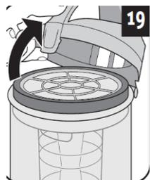
Drücken Sie die obere Staubbehälterdeckel-Entriegelung
