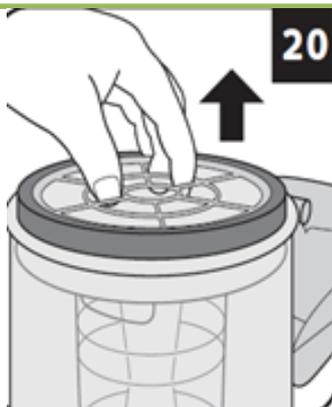
Drehen Sie den Staubbehälterdeckel, um ihn abzunehmen, und heben Sie ihn an, um den Filter herauszunehmen.
